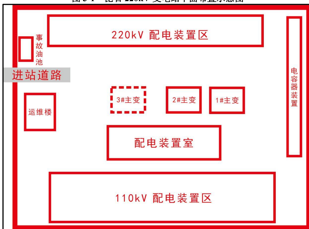
图 3-2 庄墓 220kV 变电站平面布置示意图
