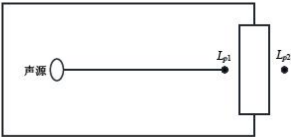
图 4.3-1 室内声源等效为室外声源图例
